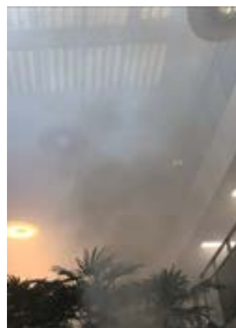
24 février 2021 Test Fumées Chaudes
